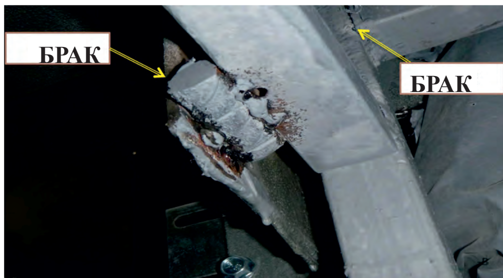
Рис. 14. Недопустимый брак – посторонние предметы в сварном шве.
