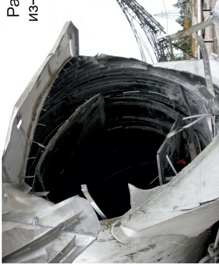
Рис.11. Разрушение емкости для хранения азота.
